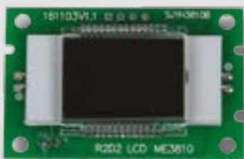
DF-43: жидкокристаллическая матрица дисплеев логических функций
